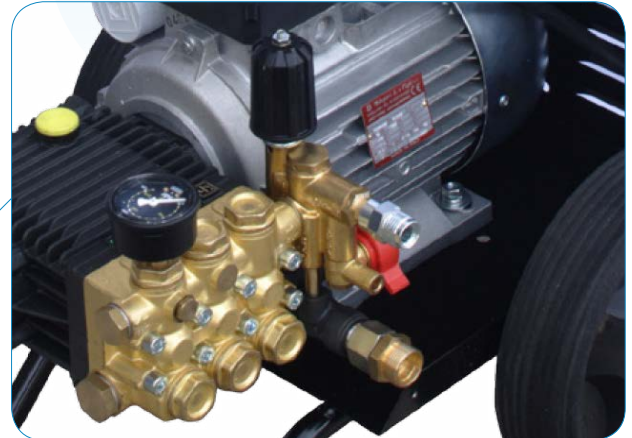
3-Kolben-Pumpe aus Keramik, Pleuel-/Kurbelsystem mit Messingkopf. 1400 UpM, 4-poliger Dauerbetrieb mit Überhitzungsschutz
