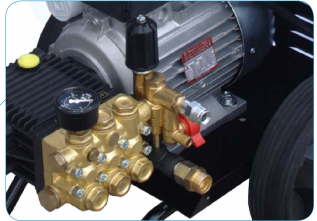
Bomba de 3 pistones cerámicos, sistema biela/manivela con cabezal de latón. Motor 1400 revoluciones servicio continuo de 4 polos, con protección térmica.
