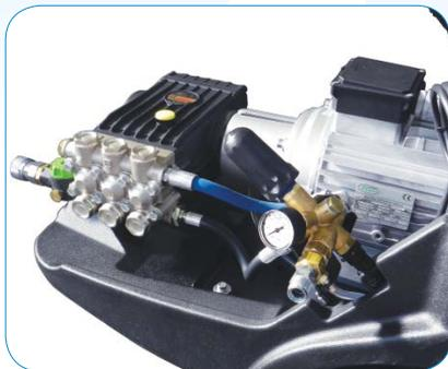
Vanne de réglage indépendante. Châssis intérieur en acier. Tableau électrique séparé du moteur.
